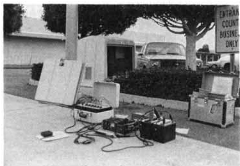
写真一6 強震観測点での常時微動測定
