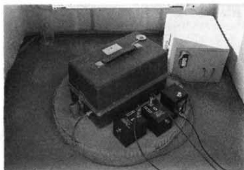
写真一5 強震計 SMA-1 と微動計 (3成分)
