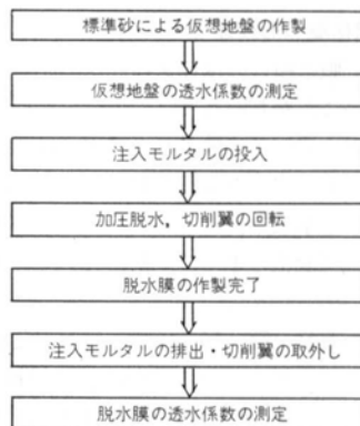
図—14 脱水膜の透水係数測定手順の概略
