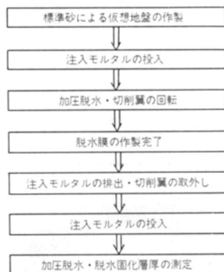
図一16 脱水固化層厚測定手順の概略
