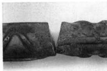
写真-2 機械切断した状態の鉄筋端面
