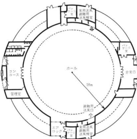
図-14 小規模空気膜構造物の平面図
