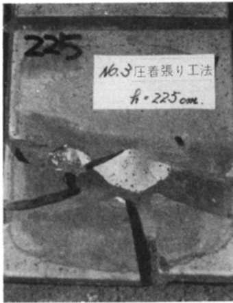
写真-4 圧着張り工法で張られたタイルの打抜き破壊
