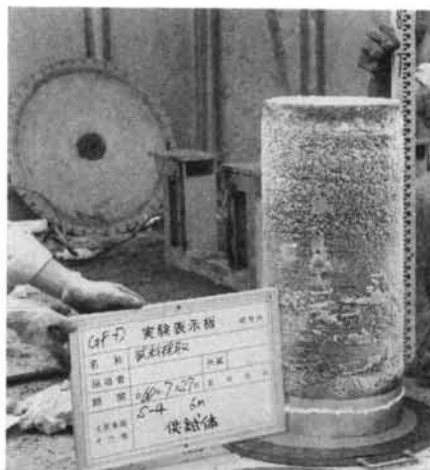
写真一6 凍結砂礫供試体
