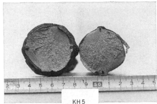
写真-11 KH型試験体の破断圧接面
