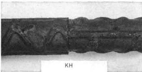
写真—4 KN, KH 型の端面突き合わせ状況 (KN 型, KH 型とも同様)
