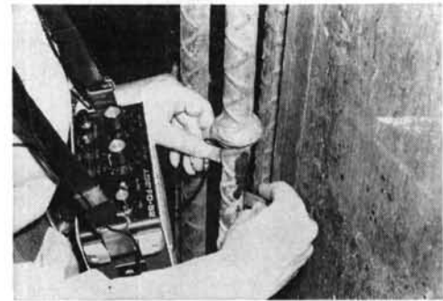
写真一五 現場における探傷状況
