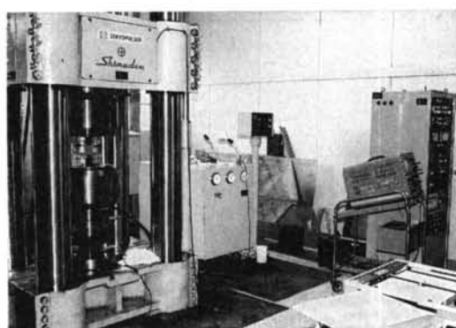
写真一 2 疲労試験機 (±60 ton)
