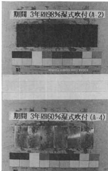
写真一六 湿式吹付岩綿内部の試験片表面状態
