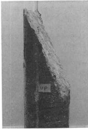
写真-1 充填コンクリートのすべり面発生状況
