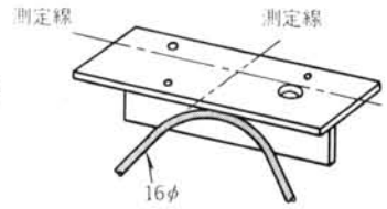
写真 4-3 第2案試験体：H-148×100×6/2
