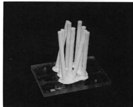
写真一 4 基礎杭の破壊状況
