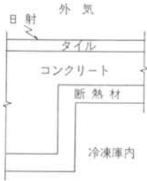
図-2 計算対象の冷凍倉庫柱部分
