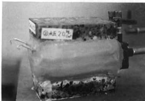
写真—4 漏水部にポリウレタンが充填されて止水された状況
