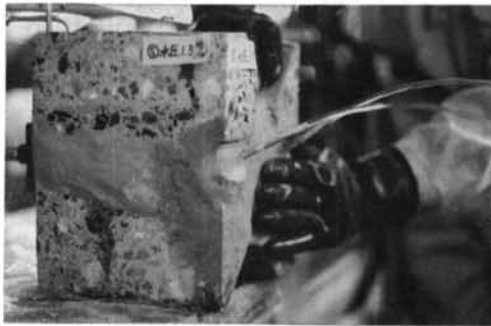
写真—2 試験体No.3の漏水下におけるポリウレタン注入空洞の作製状況
