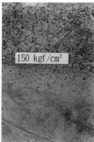
写真-2 高压水洗浄実験 (150kgf/cm²) の結果
