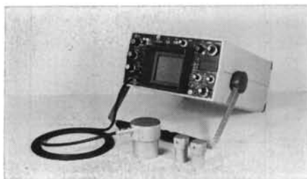
写真一 コンクリート用マルチ超音波測定器
