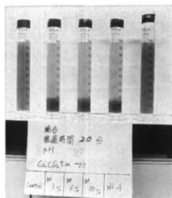
写真-3 NOC-1 による水産加工排水の処理
