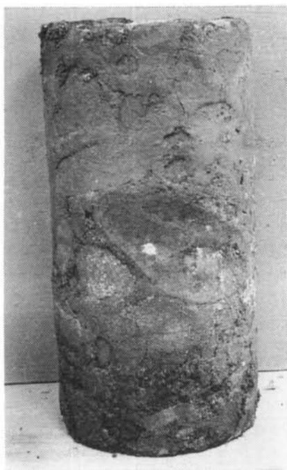
写真一 1 御殿峠礫層供試体 (三軸圧縮試験前)
