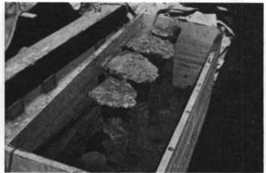
写真-3 モルタル打設実験：モルタルはいずれも十分にゆきわたり、径も変化せず、打ち込み結果良好。
