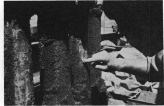
写真-4 モルタル打設実験：くいの外面には厚さ数mmのベントナイト膜があり、砂が付着している。
