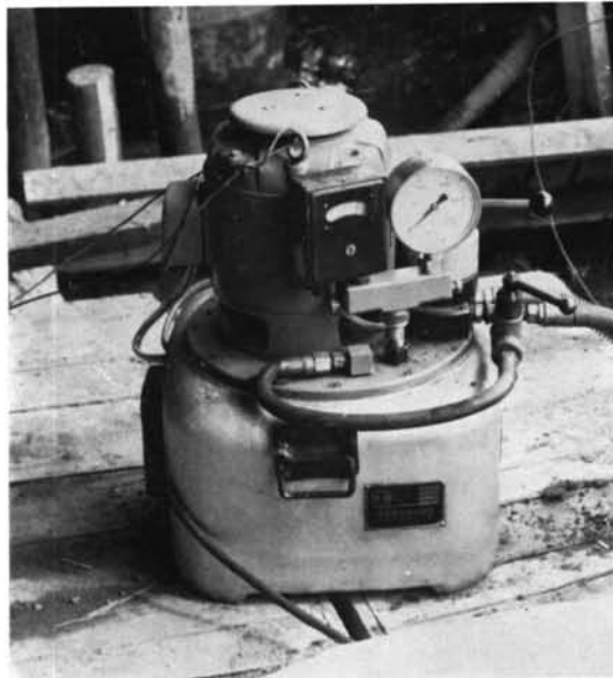
圧入に使用する電動ポンプ
