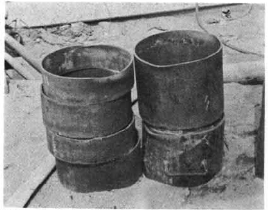
写真-3 座屈した鋼管およびダイス (座屈部分のみ切断したもの)
