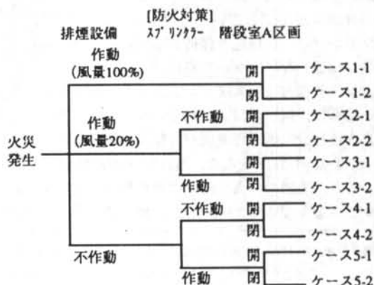
図-3 防火対策の成否に基づくイベントツリーの構成
