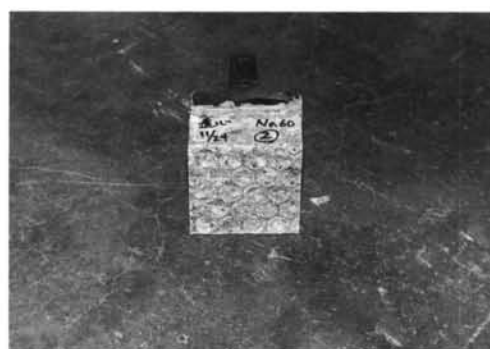
写真-12 最終破壊状況 (エアクッション・#60, 引張り)
