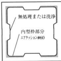
図-8 内型枠コーナー型の形状
