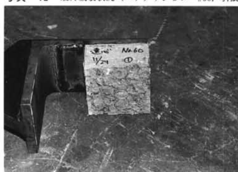
写真-13 最終破壊状況 (エアクッション・#60, せん断)
