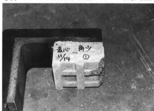
写真-11 最終破壊状況 (角型コッター・格子, せん断)
