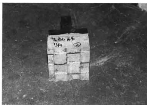
写真-10 最終破壊状況 (角型コッター・千鳥, 引張り)
