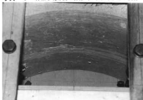
写真-6 打継ぎ境界面の仕様 (円形断面・無処理)
