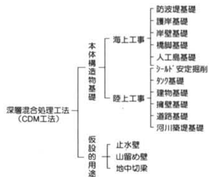
図一1 深層混合処理工法の用途
