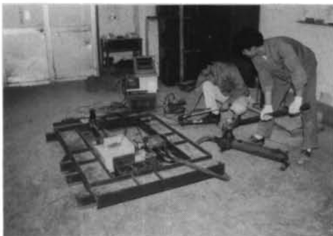
写真-5 試験体せん断実験状況
