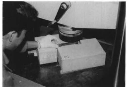
写真-4 プレーンコンクリート試験体割裂ひびわれ発生作業状況
