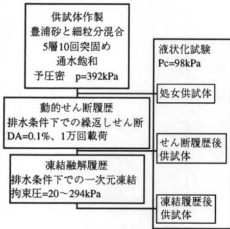
図-8 凍結融解試験の手順
