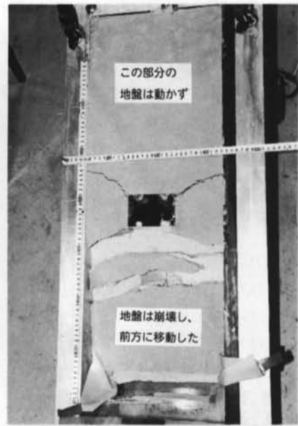
写真一 放射状に伸びる地盤亀裂の原因究明のための土槽実験結果 (1回目)
