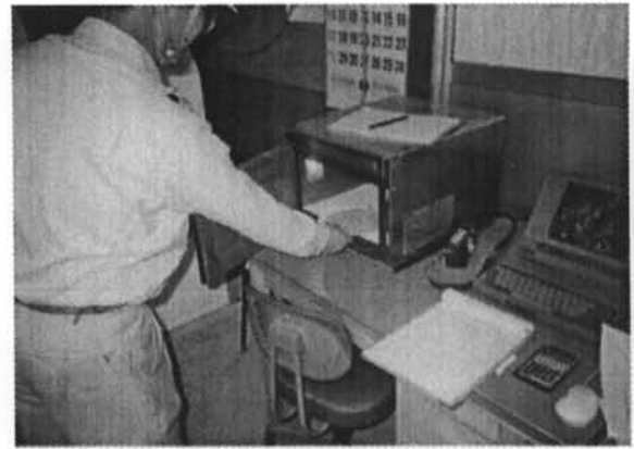
写真一3 水セメント比の管理(高周波加熱乾燥法)程で躯体を構築した。
