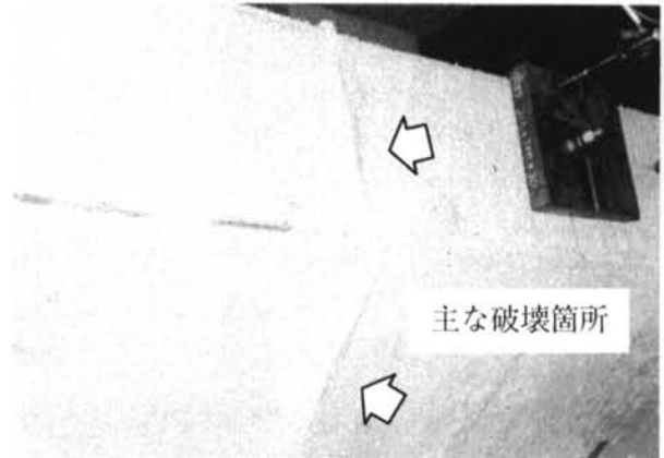
写真-9 試験体の破壊状況
