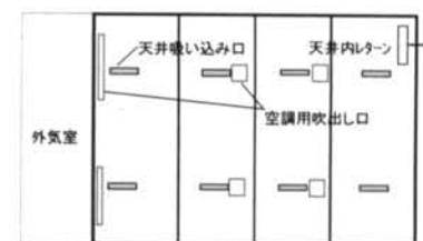
図-10 室内吹出し、およびレターン位置
