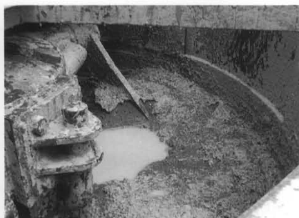
写真-2 ボルテックスミキサーを用いたエタノール/ベントナイトスラリーと砂との混合
