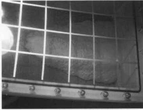
写真-9 スラリーの水中打設状況 (傾斜角 30°)
