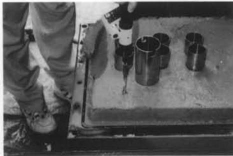
写真-10 スラリー解体時のサンプリングとベーンせん断試験
