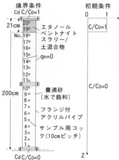
図—2 カラム実験と対応する拡散解析の初期、境界条件
