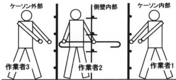
図-8 作業配員の状況
