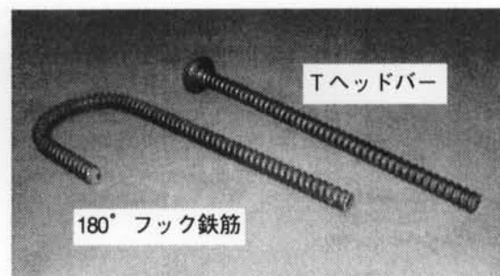
写真-1 Tヘッドバーと180°鉄筋
