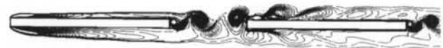
図-20 タンデム配置された B/D=20 矩形断面柱まわりの瞬間渦度場(ねじれ強制加振時： \theta = \pm 2^\circ 、 U/B=15 ) 22)
