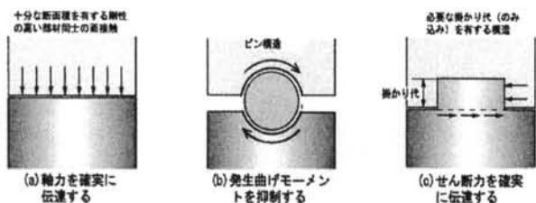
図-1 杭頭デバイスの要求性能と各性能に対する理想形状
