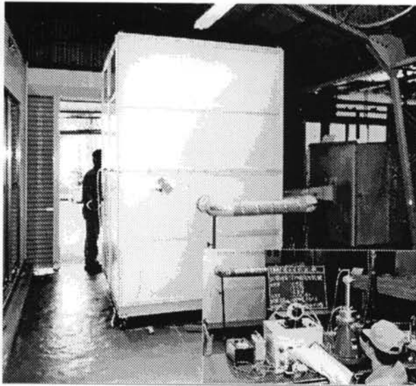
写真-2 室内建具の差圧試験
