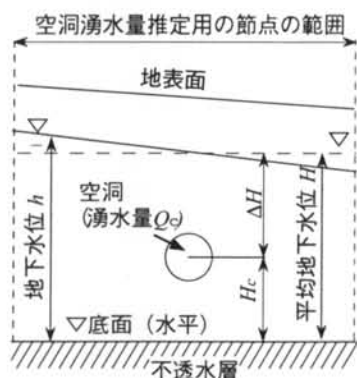
図-2 空洞湧水量の入力条件のモデル化
