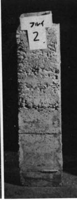
打継時間間隔.....5時間 上層の締固め.....なし
