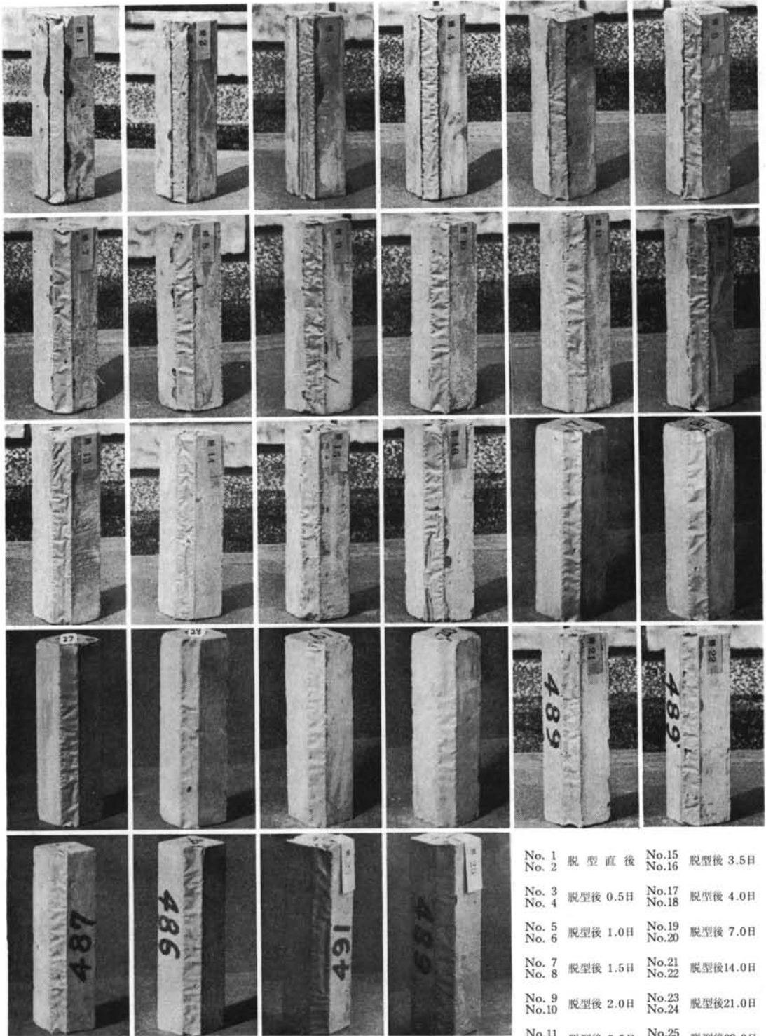
写真—6 被着体の含水率を変えた場合——充填後シールしたもの
