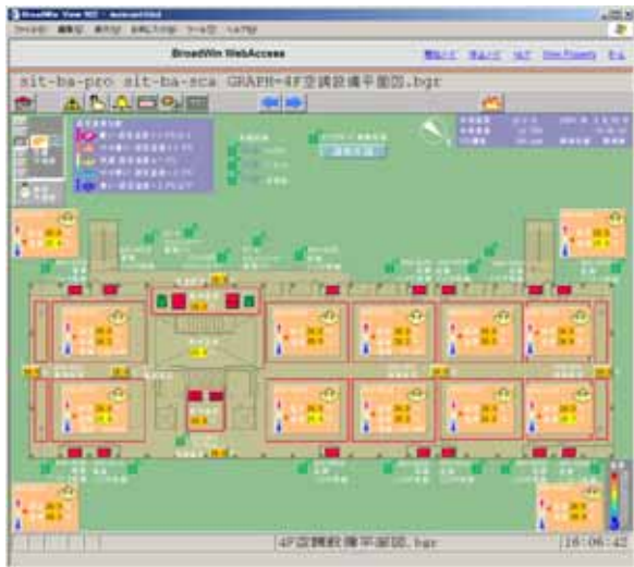
図 - 1 4 ビル管理システムの WEB 画面
