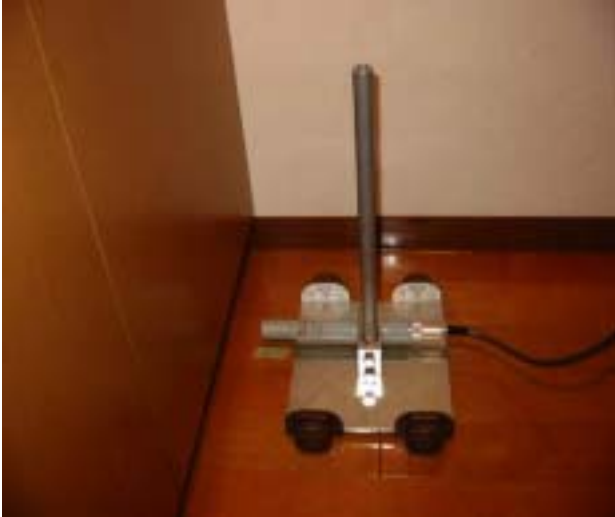
図 - 1 1 架台の使用 架台にプローブを載せて壁の前で測定している。
