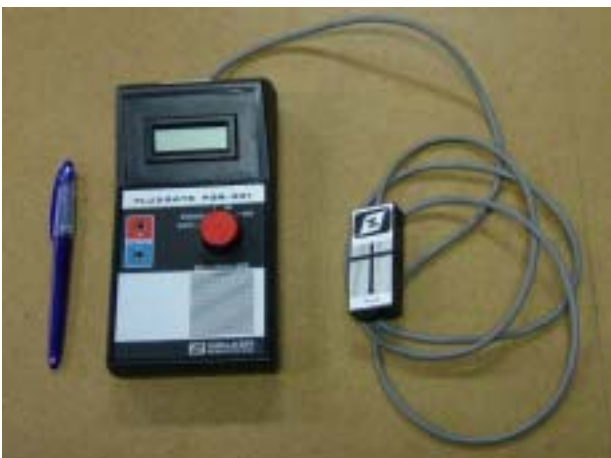
図 - 1 . 2 磁気測定機の場合 フラックスゲート型の一軸携帯型。 低磁場の測定用
