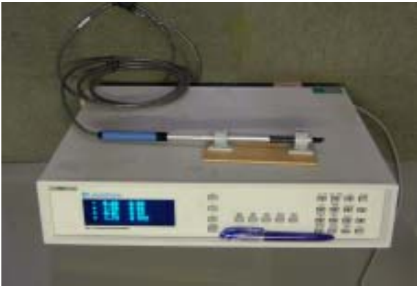
図 - 1 . 1 磁気測定機の場合 ホール素子を使う三軸卓上型。 やや高い磁場測定に使う。
