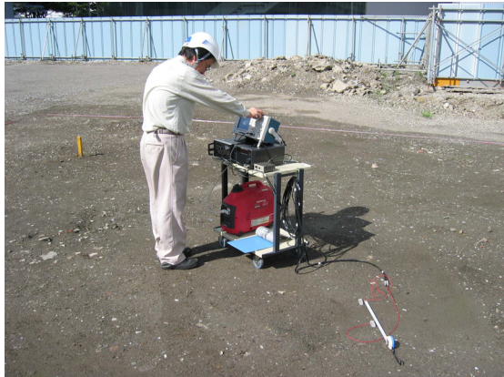
写真-2 原位置でのせん断波速度測定の様子
