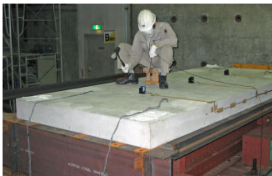
写真 - 3 インパルスハンマー打撃試験状況
