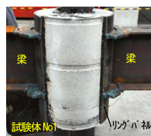
写真-8 内部のコンクリート
