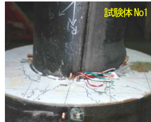
写真-2 柱の局部座屈
