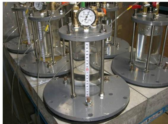
写真-2 加圧透水試験状況
