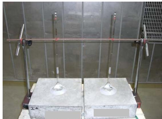
写真-1 漏斗法透水試験状況
