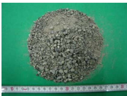
写真-5 粉砕後のコンクリート片試料
