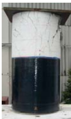
写真－1 最終破壊状況(No. 1-1) [上]：全景，[下]：杭頭接合部拡大
