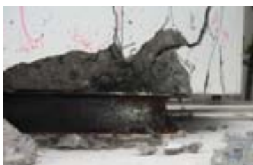
写真－1 最終破壊状況(No. 1-1) [上]：全景，[下]：杭頭接合部拡大
