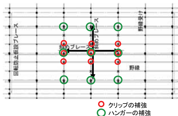
図-3 提案する天井の補強箇所
