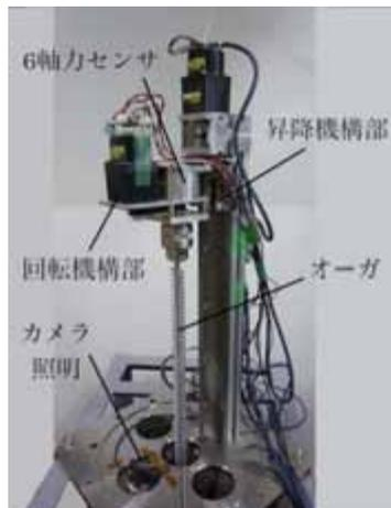
写真-1 月面用ドリル駆動部および土槽
