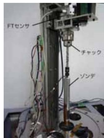
写真-5 地盤力学計測装置
