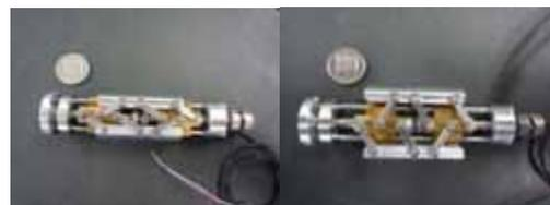
写真-4 ゾンデの収縮と膨張(内部機構)
