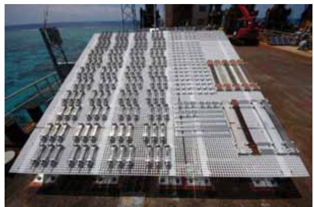
写真-4 フェーズⅢの暴露状況 (沖ノ鳥島作業基地上)
