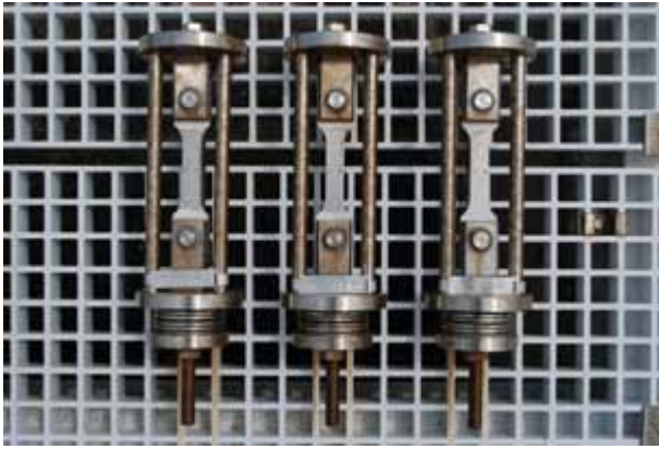
写真-6 軸力有り試験片の暴露状況 3年目 (ステンレス鋼、高軸力、宮古海岸、スリット有り、3年)
