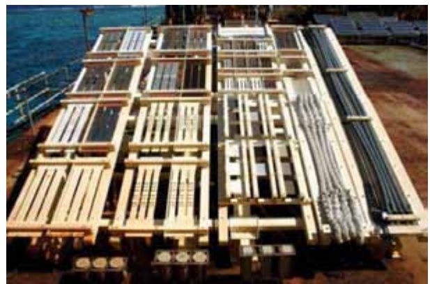
写真-3 フェーズⅡの暴露状況 (沖ノ鳥島作業基地上)
